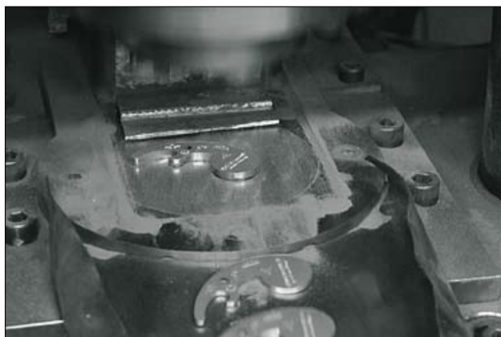
En sinterdetalj som pressats fram i en pulverpress.
